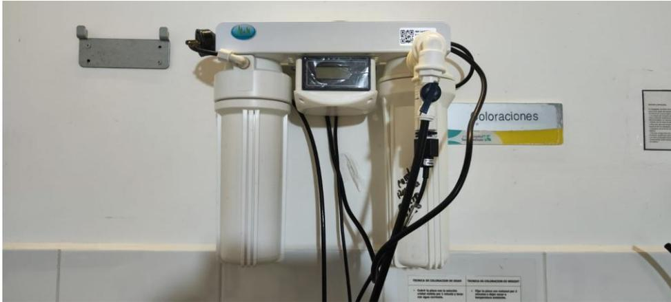
Desionizador de agua para laboratorio
